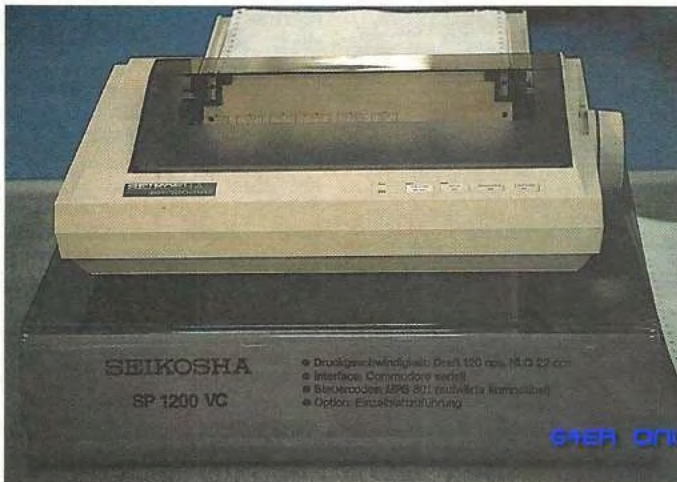
Bild 8. Seikosh SP 1200 VC: Der 9-Nadeldrucker ist direkt am Commodore-Computer anschließbar
